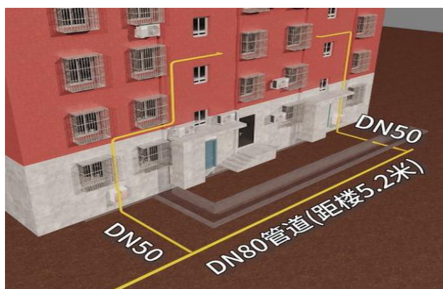
13 号楼北侧燃气管道示意图
