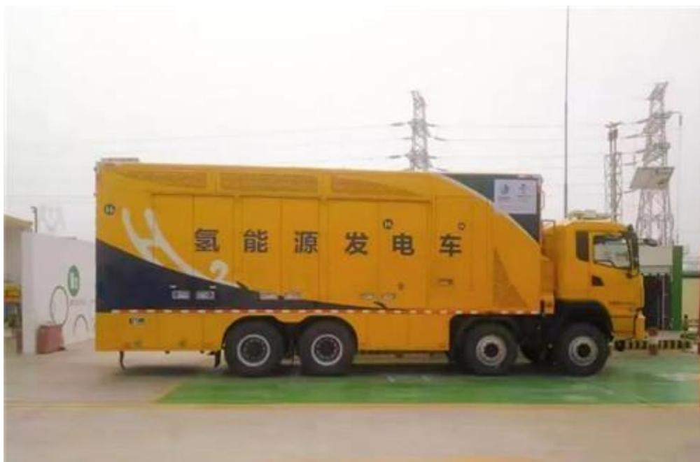
图 2-2 车载氢能应急电源装备
