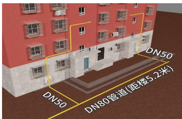
13 号楼北侧燃气管道示意图
