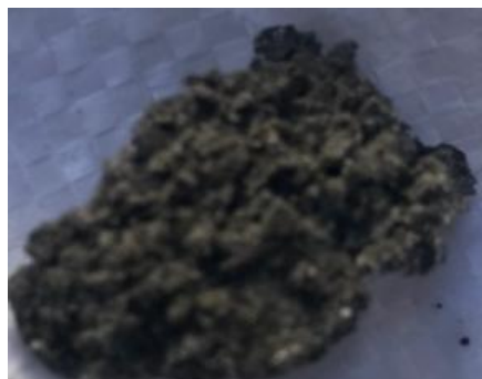
粉碎机叶片底部碳化的物块
